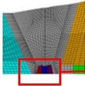
**Step 2 - Back gouge Apply 3 Alloy 182 back gouge passes**
