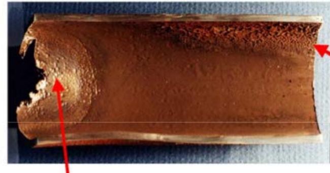
HRSG tube failure (EPRI, 2005)
