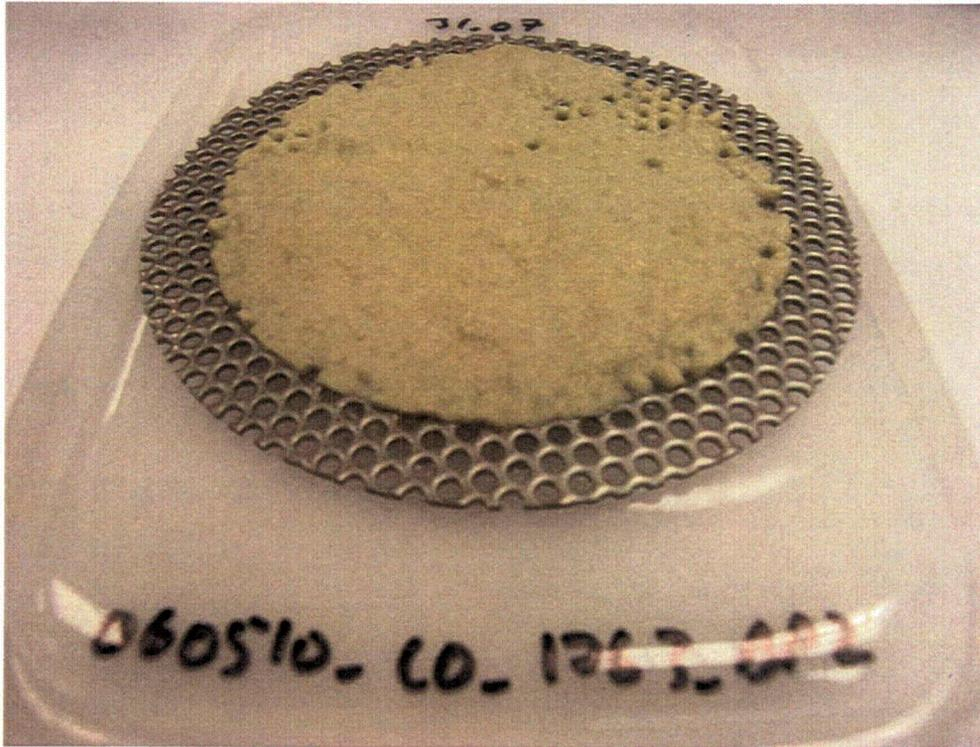
Figure I.2.11. 060510\_CO\_1763\_BP2 Debris Bed Post-Retrieval
