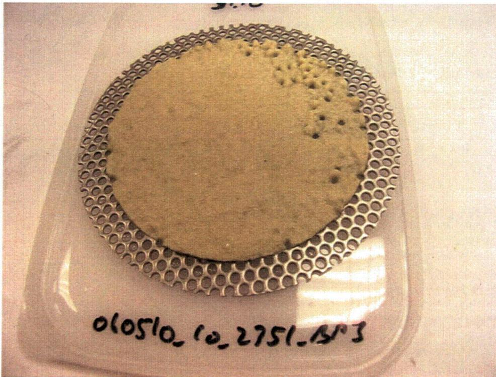
Figure I.2.12. 060510\_CO\_2751\_BP3 Debris Bed Post-Retrieval
